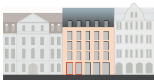
Abb. 10: Schaufenster in Lochfassade, größer als Fenster im OG, aber mit Achsbezug, Anteil von Wandschäften bleibt erlebbar
