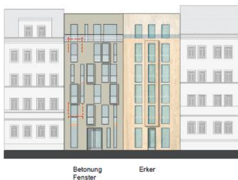
Abb. 12: Ausbildung von vortretenden Bauteilen
